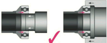
使用simatool軸承安裝工具如FT33或MK1030能有效避免軸承、滾道和軸的損傷，從而大大延長軸承使用壽命
